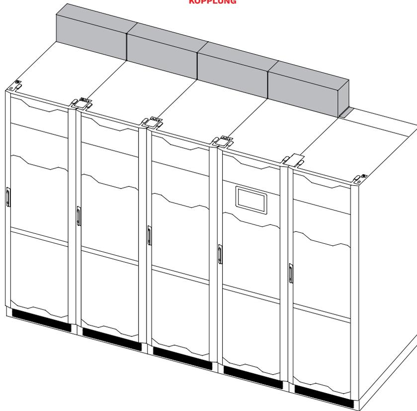
**KONFIGURATION MIT OBERER LÜFTUNG**
